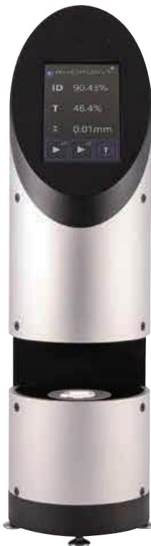
**Rhopoint ID** 使用了苏黎世联邦理工学院开发的一种称为光 照扩散强度 (Illumination Diffusion-ID) 的新度量，以响应 业界的呼吁，以寻找一种测量透明材料透射特性的新方法。 透明材料的浑浊，“朦胧”外观是决定其适用性的重要属性。 例如，通常要求包装材料最大程度地透明以便展现鲜艳的 颜色和产品的更丰富的细节，而对于化妆品则需要高不透明 性。用于量化透明材料的外观常规方法通常采用专用的“雾 影仪”来测量，该仪器被配置为量化在与入射光束的方向成 一定角度范围内散射的光量。
