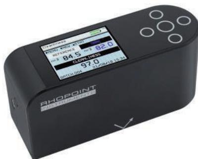
**Novo-Shade Duo+** 反射率/遮盖力仪是一种用于测量反射率的通用解决方案。它的标准配置几何 $45^{\circ}/0^{\circ}$ 允许客观测量表面的阴影或不透明度。
